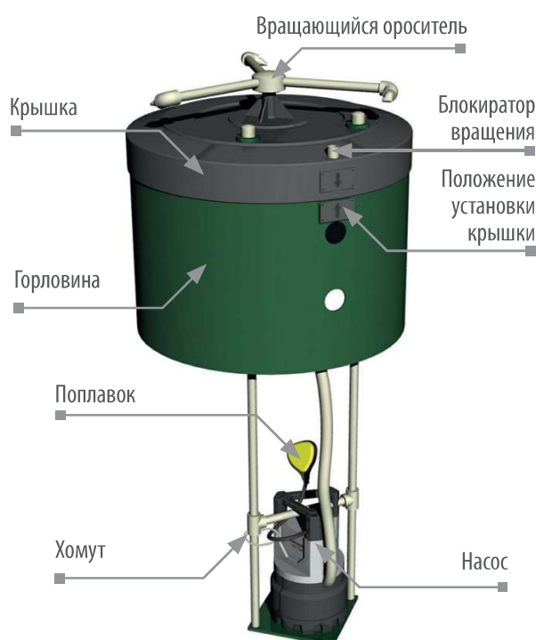
Рисунок 17. Установка циркуляционного насоса Станции.
